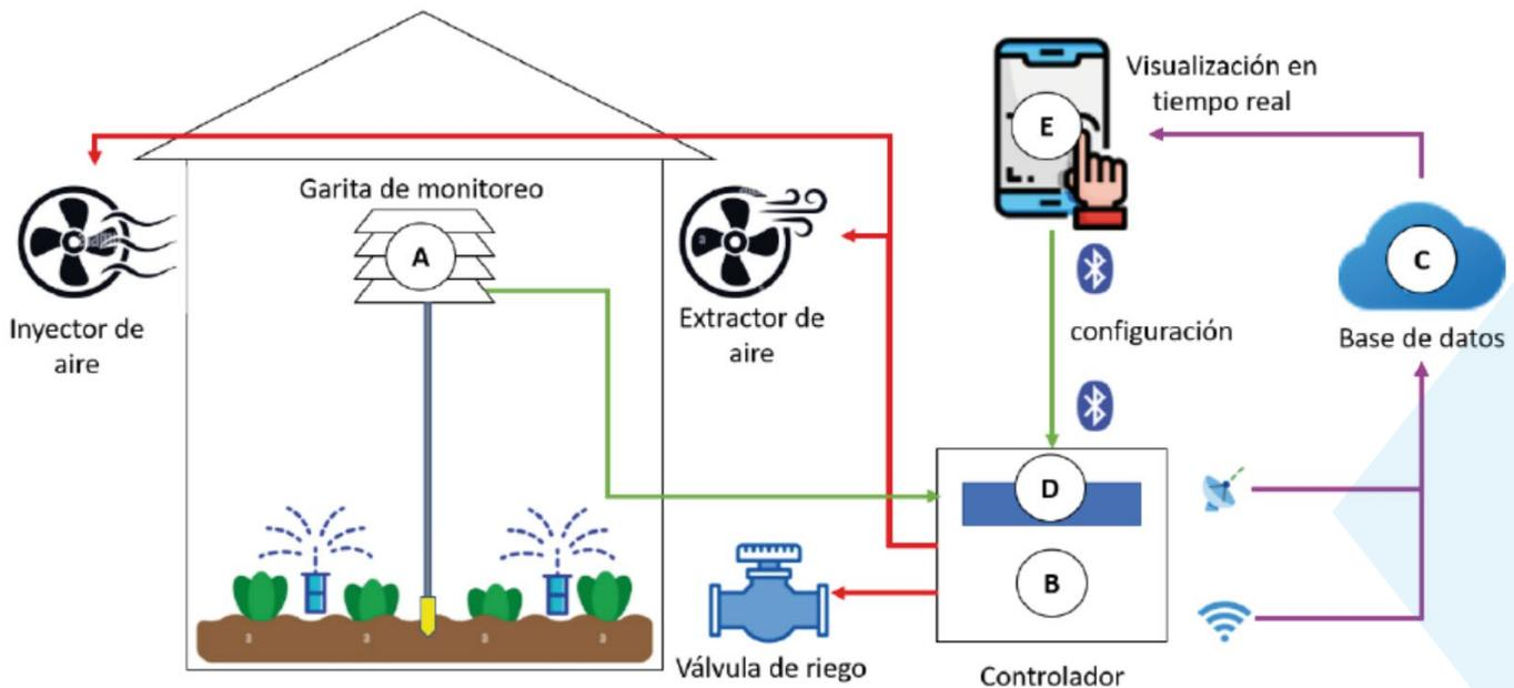
*Imagen sobre las características y funcionamiento del equipo: A) Sensores y parámetros de medición, B) Funcionamiento, C) Transmisión de datos e integración, D) Pantalla de visualización y E) Aplicación Android de configuración y monitoreo.*
